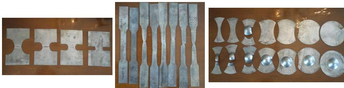
Şekil 14. DC04 sac malzemenin çekme makinesinde ve Erichsen makinesinde deformasyonu sonrası durum.
