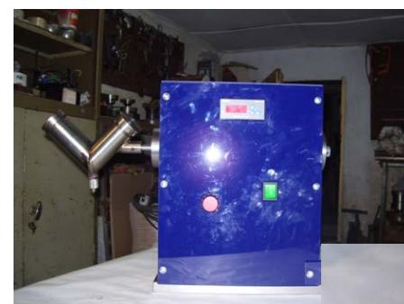
**Şekil 1.** Laboratuvar V tipi toz karıştırıcı.
