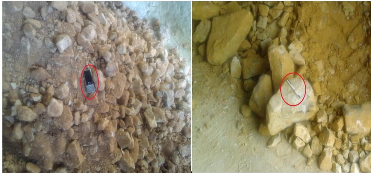
Şekil 1. Fabrikada dejirmene beslenen kuvars ve kaolen malzemelerinin boyutu
