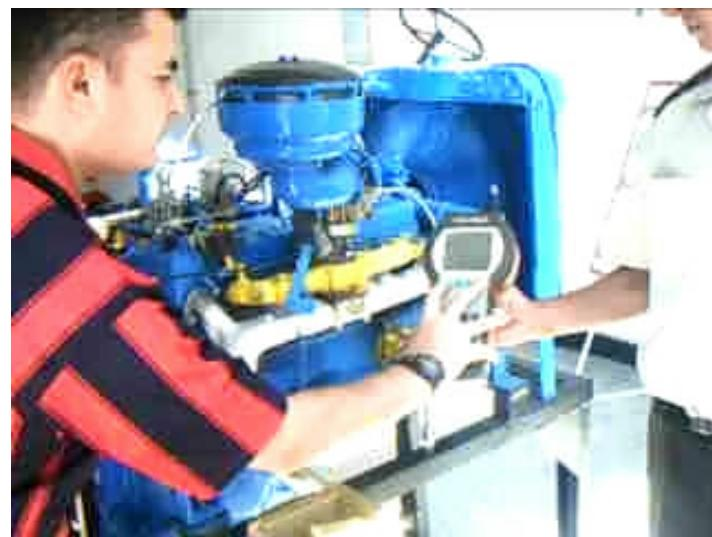
**Şekil 5.** Vibrotest 60 ile Titreşim Ölçümü [12, 13]. (Vibration Measurement with VibroTest 60)
