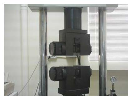
Şekil 11. Dartec marka çekme deneyi cihazı [13].
